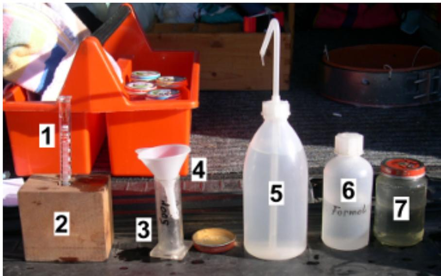
Abbildung 5.2: Weitere Utensilien: Messröhrchen [1], Ständer [2], Rohr mit 500  $\mu\text{m}$  Netz [3], Trichter [4], Spritzflasche [5], Formaldehydlösung 20 % [6], Probengefäß [7].
